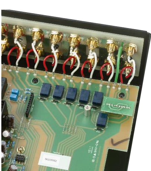
Hochwertige Cinch-Buchsen, kurze Kabelwege, Relais zur Eingangswahl
