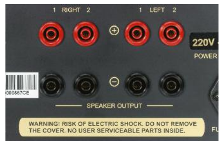
Anschlüsse für Lautsprecher nur als Banana-Buchsen, dafür aber in Bi-Wiring-Ausführung
