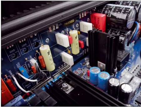
Zwei Paar Leistungstransistoren besorgen die Ansteuerung der Lautsprecher
